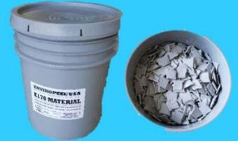
エンバイロピールは専用の機械(ユニット)で170℃程度に溶融し、吹き付けて構造物を腐食から守る弾性防食コーティング材です。
