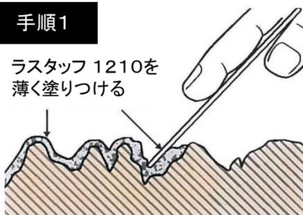
凹凸面に確実に押し付けながらラスタッフ 1210を塗りつける
