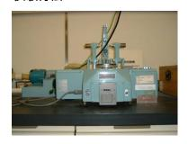
・電気絶縁抵抗試験 「電気絶縁性を高め「さび」を防止する」 体積抵抗率
